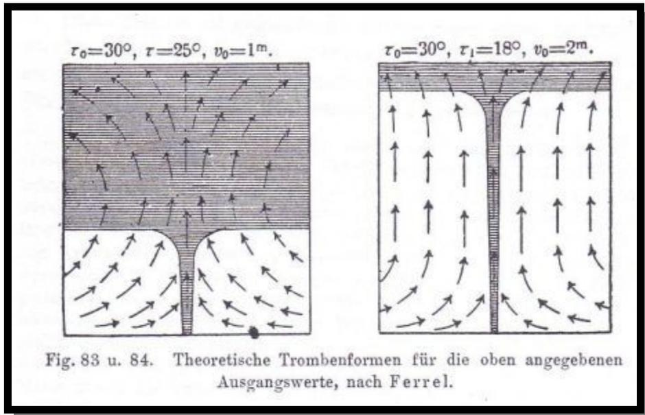
Fig. 83 u. 84. Theoretische Trombenformen für die oben angegebenen Ausgangswerte, nach Ferrel.
